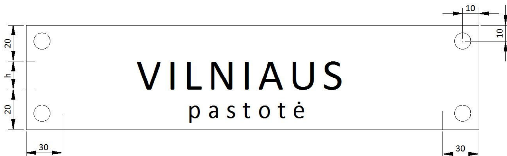
1 pav. 110-400 kV transformatorių pastočių pavadinimo lentelė
